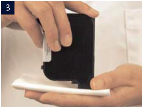
3. Posizionare la cartuccia sul panno umido con gli ugelli rivolti verso il basso. Con un po' di pressione tenere premuto per un paio di secondi per fermare il defluire dell'inchiostro.
